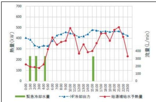
図4 ● 8月14日 HP冷却出力・給湯補給水予熱量
